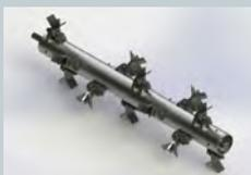
Rotore equipaggiabile con coltelli per una maggiore capacità di sminuzzamento e minore richiesta di potenza.
